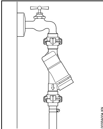
Pentru racordarea la rețeaua de apă potabilă trebuie să se instaleze o supapă de return între robinetul de apă și furtun. Tipul constructiv al supapei de return trebuie să satisfacă cerințele reglementărilor specifice locale aflate în vigoare.
