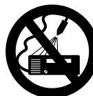
На сам агрегат, а также на другие электроприборы запрещается направлять высоконапорную струю или струю водяного шланга – опасность короткого замыкания!
