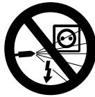
Električna postrojenja, priključke i strujne vodove ne prskati s visokotlačnim mlazom ili sa crijevom za vodu – **opasnost od kratkog spoja!**
