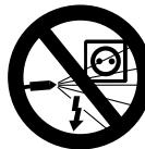
Nu stropiți cu jetul de înaltă presiune sau cu furtunul cu apă aparatele electrice, racordurile și cablurile străbate curătătoare de curent – **pericol de scurtcircuitare!**
