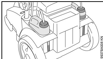
Уровень заправки каждого резервуара можно считать через выемки в корпусе.
