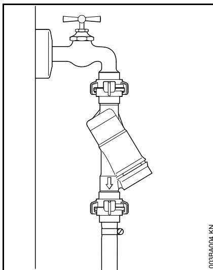
Kod priključivanja na vodovodnu mrežu potrebno je između slavine za vodu i crijeva instalirati blokadu za povratni tok. Blokada povratnog toka mora biti u skladu s lokalnim propisima.
