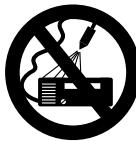
Nie spryskiwać strumieniem wody pod wysokim ciśnieniem lub wodą z węża samego urządzenia ani innych urządzeń elektrycznych — **zagrożenie wystąpieniem zwarcia!**
