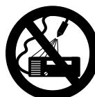
Sam uređaj i ostale električne uređaje nikada ne prskati s visokotlačnim mlazom ili sa crijevom za vodu – **opasnost od kratkog spoja!!**
