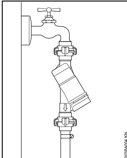
Przy podłączaniu do sieci wody pitnej między zaworem odcinającym dopływ wody a wężem należy zamontować zawór zwrotny. Konstrukcja zaworu zwrotnego musi być zgodna z obowiązującymi przepisami krajowymi.
