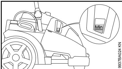
Poziom oleju należy sprawdzać co tydzień, a także po transporcie urządzenia.
