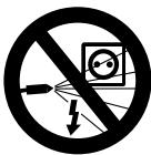
Nie spryskiwać strumieniem wody pod wysokim ciśnieniem lub wodą z węża instalacji elektrycznych, przyłączy lub przewodów pod napięciem — **zagrożenie wystąpieniem zwarcia!**
