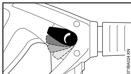
С помощью регулирующего рычага рабочее давление и кол-во подачи воды может регулироваться небольшими шагами.
