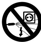
Электрооборудование, соединения и токопроводящие провода не обрызгивать струей из высоконапорного или водяного шланга – опасность короткого замыкания!
