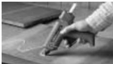
Соединения больших поверхностей требуют обильного нанесения клея (например, змеевидными линиями).
